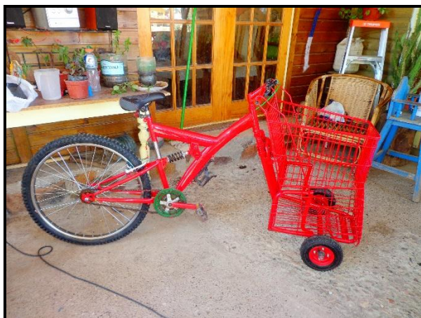
Figura 2. “Recicleta” construida para mejorar el traslado de residuos hacia el Punto Limpio.
